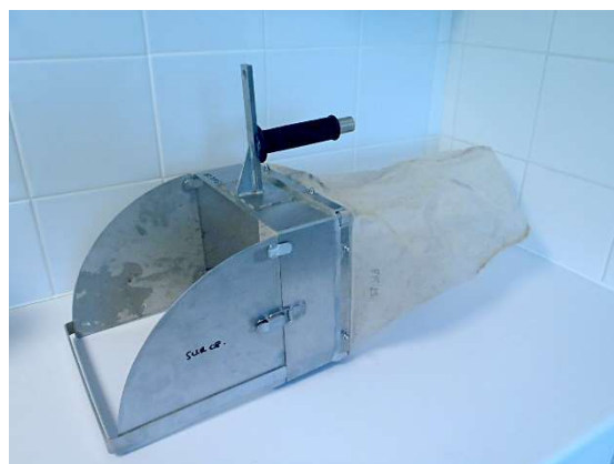
Figure 2 : filet surber destiné à la capture de larves d'invertébrés benthiques
