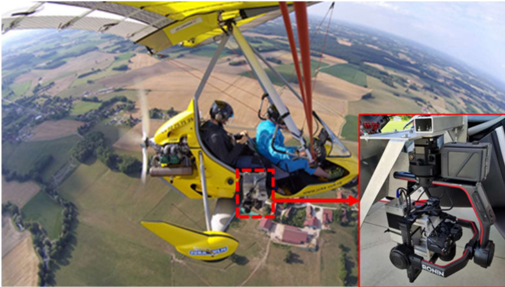
Figure 8 : Stabilisateur embarquant les capteurs optique et thermique installés sur le côté de l'ULM. (Crédit : S. Blanchon – Jura ULM©).
